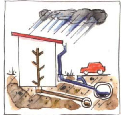
Abb. 35: Schematische Darstellung eines Trennsystems (Quelle: Altenrhein 2025)
