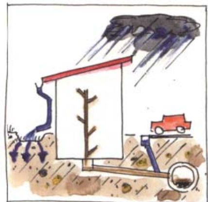
Abb. 36: Schematische Darstellung eines modifizierten Mischsystems (Quelle: Altenrhein 2025)
